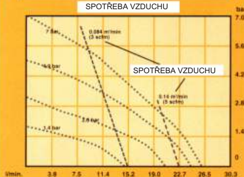
VÝTOK KAPALINY s HYTRELOVÝMI membránami a koulemi
